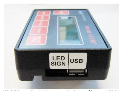
LED SIGN: Dies ist der Kommunikationsanschluss zum LED Display Array
