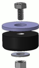
Abbildung 3: Detailbefestigung von Montagmaterialien
