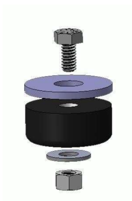
Figure 3 : Détail des matériaux d'assemblage de fixation
